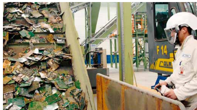
Einsatz von Sekundärrohstoffen zur Erzeugung von Kupferkathoden bei der Aurubis AG in Lünen
